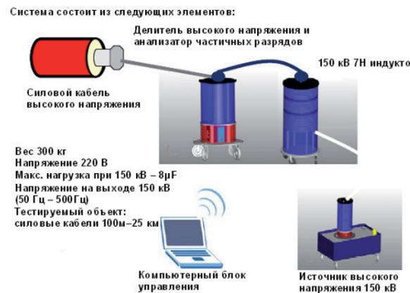
**Рис. 2. Вид собранной системы OWTS HV 150 при испытании кабельной линии 110 кВ в реальных условиях**
